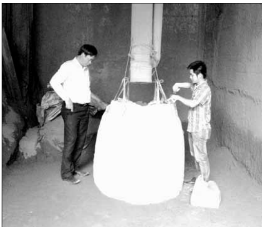
▲ Kiểm tra, thu mẫu bụi lò luyện thép tại Chi nhánh Công ty CP Thép Pomina, Bà Rịa - Vũng Tàu
